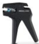
Abisolierwerkzeug, für Leiter und Kabel von 0,08 bis 2,5 mm Leiterquerschnitt, selbstjustierend, Abisolierlänge einstellbar bis 15 mm, Schneidvermögen bis 6 mm<sup>2</sup> flexibel / 1,5 mm<sup>2</sup> starr
