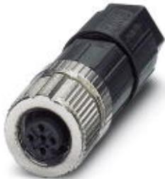
Steckverbinder, 4-polig, Buchse gerade M12, A-kodiert, Push-in-Anschluss, Rändelmaterial: Zinkdruckguss, vernickelt, Kabelaußendurchmesser 4 mm ... 8 mm
