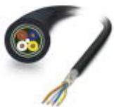
Netzwerkkabel, PROFINET CAT5 (100 MBit/s), 4-polig, PE-X halogenfrei, schwarz RAL 9005, geschirmt, freies Leitungsende, auf freies Leitungsende, Kabellänge: Freie Eingabe (0,5 ... 400 m), für Bahnanwendungen
