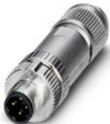
Steckverbinder, PROFINET CAT5 (100 MBit/s), 4-polig, geschirmt, Stecker gerade M12, D-kodiert, Push-in-Anschluss, Rändelmaterial: Zinkdruckguss, vernickelt, Kabelaußendurchmesser 4 mm ... 8 mm
