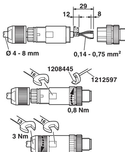
Druckmutter und Tüllengehäuse auf die Leitung schieben, Leitung abmanteln, Schirm kürzen, Einzeladern abisolieren, Adern anschließen, bei geradem Tüllengehäuse Adern leicht miteinander verdrehen, Schirmfolie um den gekürzten Schirm kleben, bei Leitungsaußendurchmesser < 6 mm eine zusätzliche Schirmfolie um das Adernpaket kleben, Tüllengehäuse mit dem Steckereinsatz verschrauben, Druckmutter festschrauben.
