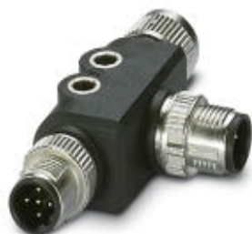
T-Verteiler, PROFIBUS DP (12 MBit/s), 5-polig, geschirmt, Buchse gerade M12, B-kodiert, auf Stecker gerade M12, B-kodiert und Stecker gerade M12, B-kodiert
