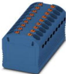
Verteilerblock, intern gebrückt, Nennspannung: 450 V, Nennstrom: 17,5 A, Anschlussart: Push-in-Anschluss, Anzahl der Anschlüsse: 18, Querschnitt: 0,14 mm<sup>2</sup> - 1,5 mm<sup>2</sup>, AWG: 26 - 16, Breite: 37,8 mm, Höhe: 17,6 mm, Farbe: blau, Montageart: Direktmontage mit Flansch
