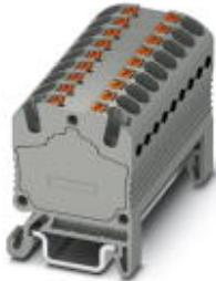
Verteilerblock, intern gebrückt, Nennspannung: 500 V, Nennstrom: 17,5 A, Anschlussart: Push-in-Anschluss, Anzahl der Anschlüsse: 18, Querschnitt: 0,14 mm<sup>2</sup> - 1,5 mm<sup>2</sup>, AWG: 26 - 16, Breite: 40 mm, Farbe: grau, Montageart: NS 15
