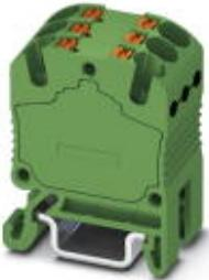
Verteilerblock, intern gebrückt, Nennspannung: 500 V, Nennstrom: 17,5 A, Anschlussart: Push-in-Anschluss, Anzahl der Anschlüsse: 6, Querschnitt: 0,14 mm<sup>2</sup> - 1,5 mm<sup>2</sup>, AWG: 26 - 16, Breite: 12,5 mm, Farbe: grün, Montageart: NS 15
