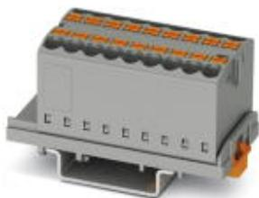
Verteilerblock, Block mit senkrechter Ausrichtung, Nennspannung: 500 V, Nennstrom: 24 A, Anschlussart: Push-in-Anschluss, Anzahl der Anschlüsse: 18, Querschnitt: 0,14 mm<sup>2</sup> - 4 mm<sup>2</sup>, AWG: 26 - 12, Breite: 28,6 mm, Höhe: 28,7 mm, Farbe: orange, Montageart: NS 35/7,5, NS 35/15
