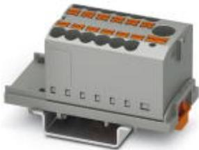
Verteilerblock, Block mit senkrechter Ausrichtung und integrierter Einspeisung, Nennspannung: 500 V, Nennstrom: 24 A, Anschlussart: Push-in-Anschluss, Push-in-Anschluss, Anzahl der Anschlüsse: 13, Querschnitt: 0,14 mm<sup>2</sup> - 4 mm<sup>2</sup>, AWG: 26 - 12, Breite: 28,6 mm, Höhe: 28,7 mm, Farbe: grau, Montageart: NS 35/7,5, NS 35/15
