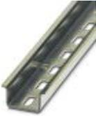
Tragschiene gelocht, Standardprofil, Breite: 35 mm, Höhe: 15 mm, ähnlich EN 60715: 2001, Material: Stahl, verzinkt, dickschichtpassiviert, Länge: 2000 mm, Farbe: silberfarben
