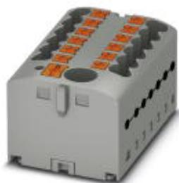
Verteilerblock, Grundklemme mit Einspeisung, Nennspannung: 500 V, Nennstrom: 24 A, Anschlussart: Push-in-Anschluss, Push-in-Anschluss, Anzahl der Anschlüsse: 13, Querschnitt: 0,14 mm<sup>2</sup> - 4 mm<sup>2</sup>, AWG: 26 - 12, Breite: 40,6 mm, Höhe: 21,2 mm, Farbe: grau, Montageart: aufrasten auf Tragschienenadapter, Adapterplatte
