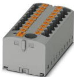
Verteilerblock, Grundklemme mit Einspeisung, Nennspannung: 500 V, Nennstrom: 24 A, Anschlussart: Push-in-Anschluss, Push-in-Anschluss, Anzahl der Anschlüsse: 13, Querschnitt: 0,14 mm<sup>2</sup> - 4 mm<sup>2</sup>, AWG: 26 - 12, Breite: 40,6 mm, Höhe: 21,2 mm, Farbe: schwarz/gelb, Montageart: aufrasten auf Tragschienenadapter, Adapterplatte
