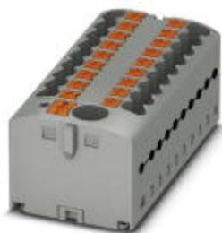
Verteilerblock, Grundklemme mit Einspeisung, Nennspannung: 500 V, Nennstrom: 24 A, Anschlussart: Push-in-Anschluss, Push-in-Anschluss, Anzahl der Anschlüsse: 19, Querschnitt: 0,14 mm<sup>2</sup> - 4 mm<sup>2</sup>, AWG: 26 - 12, Breite: 56 mm, Höhe: 21,2 mm, Farbe: grau, Montageart: aufrasten auf Tragschienenadapter, Adapterplatte
