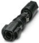
Photovoltaik-Steckverbinder, Nennstrom: 35 A, Nennspannung: 1100 V, Anschlussart: Federkraft, Farbe: schwarz.
