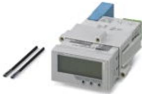
Multifunktionaler Ex-i Prozessanzeiger im Schalttafeleinbaugeschäft zur Überwachung und Darstellung von analogen Messwerten. Universaleingänge erlauben den Anschluss von Strom, Spannung, RTDs und TCs. Zwei Relaiswechslerausgänge und ein Analogausgang.
