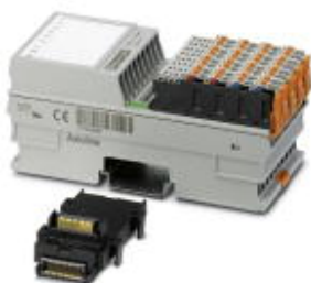
Axioline F-Analog-Eingabemodul, 8 Eingänge: 0-10 V, \pm 10 V, 0-20 mA, 4-20 mA, \pm 20 mA, für SAFE AI-Anwendungen mit servicefreiem Dauerbetrieb
