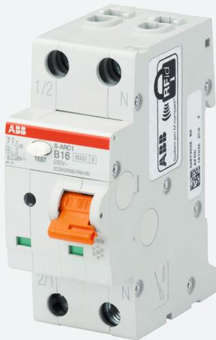
S-ARC1 ist die 1P+N Fehlerlichtbogen-Schutzeinrichtung (AFDD) mit integriertem Sicherungsautomat (MCB) und einer Breite von nur zwei Teilungseinheiten. Neben dem Überstromschutz des MCB bietet S-ARC1 zusätzlichen Schutz vor seriellen und parallelen Fehlerlichtbögen.
