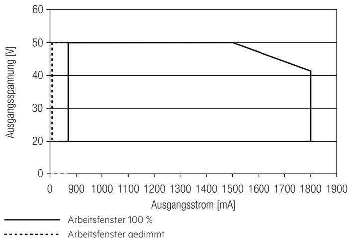
Es ist sicherzustellen, dass der LED-Treiber ausschließlich innerhalb des gezeigten Arbeitsfensters betrieben wird. Besondere Aufmerksamkeit ist dem gedimmten Betrieb sowie dem DC- und Notlichtbetrieb zu widmen, da aufgrund der verwendeten Amplituden-Dimming die Modulspannung mit dem Dimm-Level variiert. Eine Unterschreitung der spezifizierten minimalen Ausgangsspannung des LED-Treibers kann zur Abschaltung führen. Siehe Abschnitt „6.11 Lichtlevel im DC-Betrieb“ für mehr Informationen.
