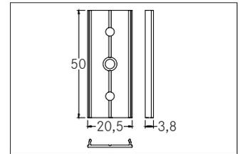
Verbindungsstück 180°, aluminium roh. Material: Aluminium, Abmessung Profil: L: 50 mm x B: 20,5 mm x H: 3,8 mm.
