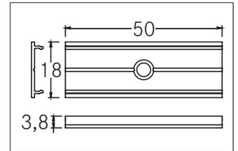
Verbindungsstück 180°, aluminium roh. Material: Aluminium, Abmessung Profil: L: 50 mm x B: 18 mm x H: 3,8 mm.
