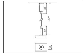
Seilabhängungsset, 1.500 mm, chrom. Material: Aluminium, Abmessung Profil: L: 1.500 mm x B: mm x H: mm.
