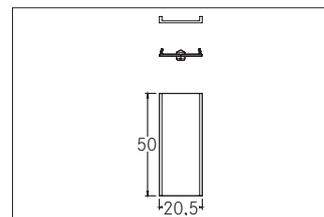
Verbindungsstück 180°, aluminium roh + transparent. Material: Aluminium, Abmessung Profil: L: 50 mm x B: 20,5 mm x H: mm.
