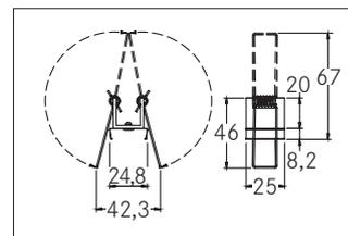
Federhalter-Set für Hohldecken (2 Stück), aluminium roh. Material: Aluminium, Abmessung Profil: L: 25 mm x B: 24,8 mm x H: 46 mm.
