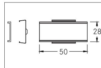
Verbindungsstück 180°, aluminium. Material: Aluminium, Abmessung Profil: L: 50 mm x B: 26 mm x H: mm.
