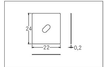
Verbindungsstück 180°, silber. Material: Aluminium, Abmessung Profil: L: 22 mm x B: 24 mm x H: 0,2 mm.
