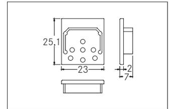
Endkappen-Set zu 53402. silber. In Verbindung mit den Profilabdeckungen 53402000 53402070 53402080 53432070 kann sowohl ein zusätzlicher mechanischer Schutz als auch eine optimale Lichtverteilung erreicht werden. Material: Aluminium, Abmessung Profil: L: mm x B: 23 mm x H: 25,1 mm.
