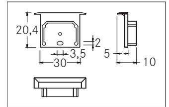
Endkappen-Set zu 53402. silber. Material: Kunststoff, Abmessung Profil: L: mm x B: 30 mm x H: 20,4 mm.
