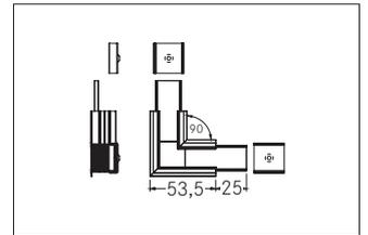
Verbindungsstück 90°, schwarz eloxiert. Material: Aluminium, Abmessung Profil: L: 53,5 mm x B: 53,5 mm x H: mm.
