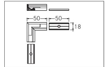
Verbindungsstück 90°, weiß. Material: Aluminium, Abmessung Profil: L: 50 mm x B: 50 mm x H: mm.
