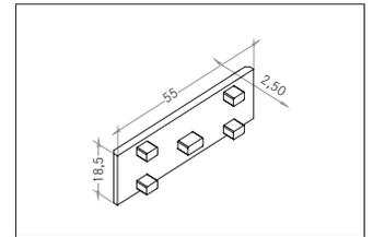
Endkappen-Set, aluminium. Material: Kunststoff, Abmessung Profil: L: mm x B: 55 mm x H: 18,5 mm.
