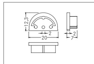
Endkappen-Set, silber. Material: Kunststoff, Abmessung Profil: L: mm x B: 20 mm x H: 12,3 mm.
