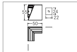
Verbindungsstück 90°, weiß. Material: Aluminium, Abmessung Profil: L: 50 mm x B: 50 mm x H: 55 mm.
