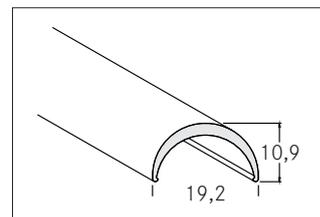
Klick-Abdeckungen: PMMA, opal. In Verbindung mit den Profilabdeckungen 53431070 kann sowohl ein zusätzlicher mechanischer Schutz als auch eine optimale Lichtverteilung erreicht werden. Material: Kunststoff, Abmessung Profil: L: 2.000 mm x B: 19,2 mm x H: 10,9 mm.
