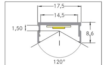
Anbauprofil, alu eloxiert. Zur optimalen Befestigung des Profiles eignen sich die Halter 53034000. In Verbindung mit den Profilabdeckungen 53440000 53440070 53440080 kann sowohl ein zusätzlicher mechanischer Schutz als auch eine optimale Lichtverteilung erreicht werden. Das zugehörige Endkappen-Set steht unter 53086070 zur Verfügung. Montageart: Anbauprofil, Material: Aluminium, Abmessung Profil: L: 2.000 mm x B: 17,5 mm x H: 8,6 mm.
