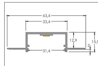
Einputzprofil, weiß. In Verbindung mit den Profilabdeckungen 53404000 53404070 kann sowohl ein zusätzlicher mechanischer Schutz als auch eine optimale Lichtverteilung erreicht werden. Das zugehörige Endkappen-Set steht unter 53091070 zur Verfügung. Montageart: Einbauprofil, Material: Aluminium, Abmessung Profil: L: 2.000 mm x B: 63,4 mm x H: 15,9 mm.
