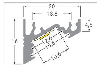
Anbau-Eckprofil, weiß. Zur optimalen Befestigung des Profiles eignen sich die Halter 53001000. Zur Verbindung von zwei Profilen ist der Verbinder 53005000 optimal geeignet. In Verbindung mit den Profilabdeckungen 53400000 53400070 kann sowohl ein zusätzlicher mechanischer Schutz als auch eine optimale Lichtverteilung erreicht werden. Das zugehörige Endkappen-Set steht unter 53070070 zur Verfügung. Montageart: Eckprofil, Material: Aluminium, Abmessung Profil: L: 2.000 mm x B: 20 mm x H: 16 mm.
