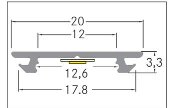
Flexibles Profil, alu eloxiert. Zur optimalen Befestigung des Profiles eignen sich die Halter 53020000 53021000 53022260. In Verbindung mit den Profilabdeckungen 53431070 kann sowohl ein zusätzlicher mechanischer Schutz als auch eine optimale Lichtverteilung erreicht werden. Das zugehörige Endkappen-Set steht unter 53078 zur Verfügung. Montageart: Spezialprofil, Material: Aluminium, Abmessung Profil: L: 2.000 mm x B: 20 mm x H: 3,3 mm.
