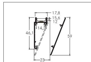
Wandanbauprofil, weiß. In Verbindung mit den Profilabdeckungen 53400000 53400070 53431070 kann sowohl ein zusätzlicher mechanischer Schutz als auch eine optimale Lichtverteilung erreicht werden. Das zugehörige Endkappen-Set steht unter 5307907053080070 zur Verfügung. Montageart: Anbauprofil, Material: Aluminium, Abmessung Profil: L: 2.000 mm x B: 17,8 mm x H: 46,1 mm.
