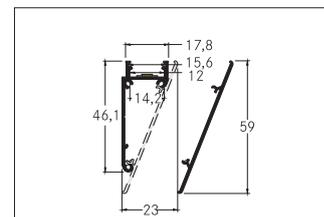
Wandanbauprofil, alu eloxiert. In Verbindung mit den Profilabdeckungen 53400000 53400070 53431070 kann sowohl ein zusätzlicher mechanischer Schutz als auch eine optimale Lichtverteilung erreicht werden. Das zugehörige Endkappen-Set steht unter 5307926053080260 zur Verfügung. Montageart: Anbauprofil, Material: Aluminium, Abmessung Profil: L: 2.000 mm x B: 17,8 mm x H: 46,1 mm.
