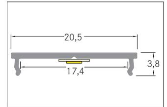
Flachprofil, schwarz eloxiert. Montageart: Anbauprofil, Material: Aluminium, Abmessung Profil: L: 2.000 mm x B: 20,5 mm x H: 3,8 mm.
