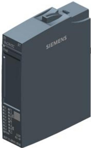
SIMATIC ET 200SP, Digitales Eingangsmodul, DI 16x 24V DC Standard, Eingangstyp 3 (IEC 61131), Sink Input, (PNP, P-lesend), Verpackungseinheit: 1 Stück, passend für BU-Typ A0, Farbcode CC00, Eingangsverzögerung 0,05..20ms; Modul-Diagnose für: Drahtbruch, Versorgungsspannung
