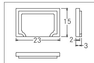
Endkappen-Set zu 53432070, opal. In Verbindung mit den Profilabdeckungen kann sowohl ein zusätzlicher mechanischer Schutz als auch eine optimale Lichtverteilung erreicht werden. Das zugehörige Endkappen-Set steht unter 53603 zur Verfügung. Material: Kunststoff, Abmessung Profil: L: mm x B: 23 mm x H: 15 mm.
