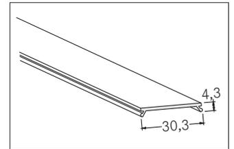
Abdeckungen , transparent. Material: Kunststoff, Abmessung Profil: L: 100 mm x B: 30,3 mm x H: 4,3 mm.
