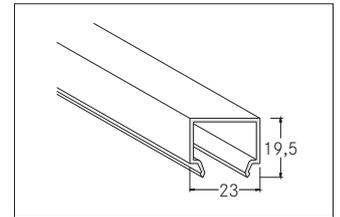
Abdeckungen: PMMA, opal. Material: Kunststoff, Abmessung Profil: L: 100 mm x B: 23 mm x H: 19,5 mm.
