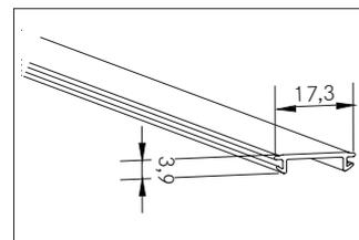
Flex-Klick-Abdeckungen: PC, transparent. Material: Kunststoff, Abmessung Profil: L: 100 mm x B: 17,3 mm x H: 3,9 mm.
