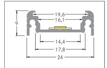
Anbauprofil, schwarz eloxiert. Material: Aluminium, Abmessung Profil: L: 100 mm x B: 24 mm x H: 9 mm.
