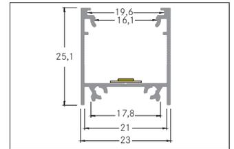
Anbauprofil, alu eloxiert. In Verbindung mit den Profilabdeckungen 53402000 53402070 53402080 53432070 kann sowohl ein zusätzlicher mechanischer Schutz als auch eine optimale Lichtverteilung erreicht werden. Material: Aluminium, Abmessung Profil: L: 100 mm x B: 23 mm x H: 25,1 mm.
