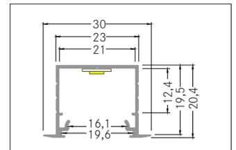
Einbauprofil, alu eloxiert. Material: Aluminium, Abmessung Profil: L: 100 mm x B: 30 mm x H: 20,4 mm.
