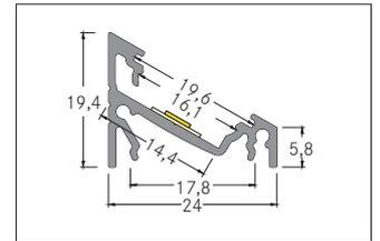
Anbau-Eckprofil, weiß. Material: Aluminium, Abmessung Profil: L: 100 mm x B: 24 mm x H: 19,4 mm.
