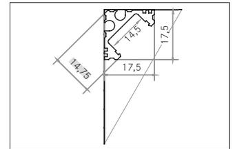
Aluminiumprofil, alu eloxiert. Material: Aluminium, Abmessung Profil: L: 100 mm x B: mm x H: mm.
