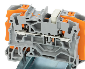
Reduzierbrücke (Bestellnr. 2006-499): von 6/4 mm 2 (Serien 2206/2204) auf 4/2,5/1,5 mm 2 (Serien 2204/2202/2201)
